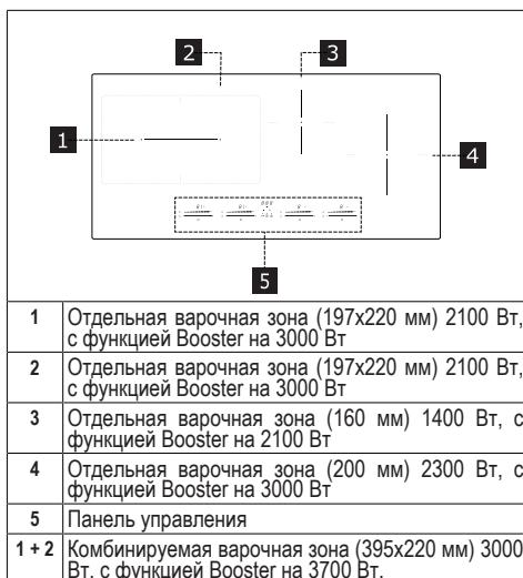
Каждая варочная зона оснащена системой, которая обнаруживает наличие кастрюли на варочной поверхности.
